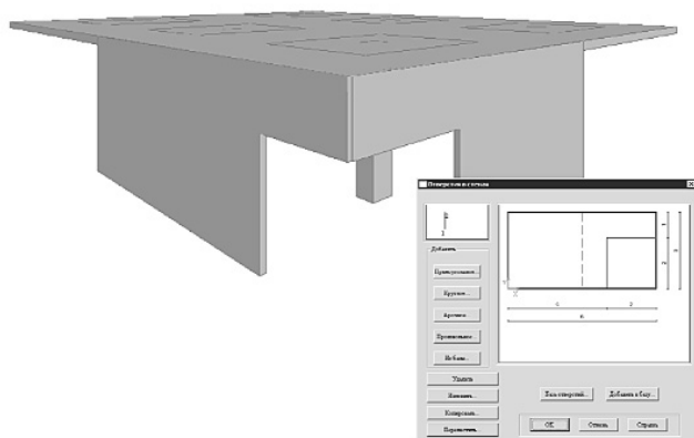
Рис. 10. Задание пересекающихся отверстий в стенах
